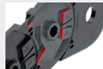
Hintergriffe am Anschlag zur besseren Krafteinleitung und höheren Festigkeiten
