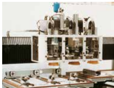
Catene Mono, MT e acciaio su centro lavorazione legno
