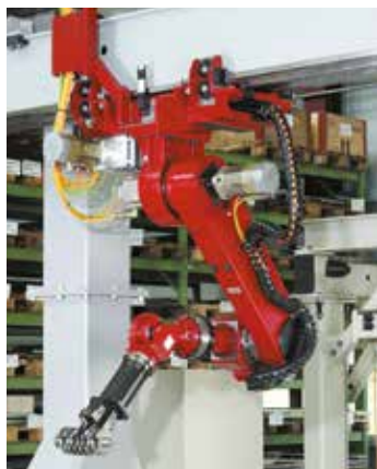
Robotrax su manipolatore Gudel
