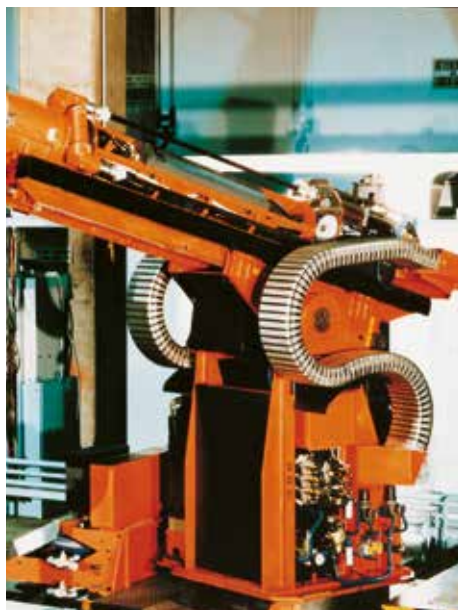
Conduflex su Robot Bisiach e Carrù
