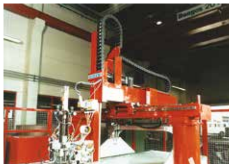
Catene Uniflex su manipolatore
