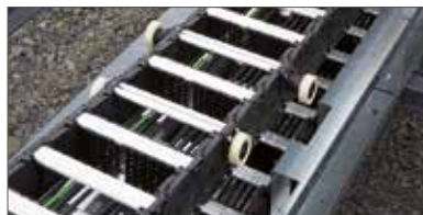
Impianto per i test corse lunghe equipaggiato con cavi TRAXLINE
