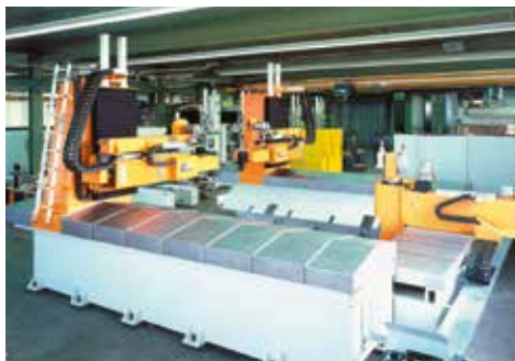
Catena Uniflex su centro di lavoro ad alta velocità
