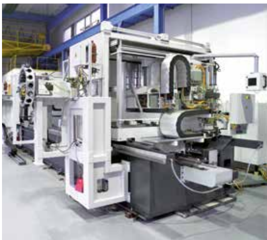
Catene portacavi serie MASTER LT su macchina lavorazione tubi. (Foto: Rottler Werkzeugmaschinen GmbH)
