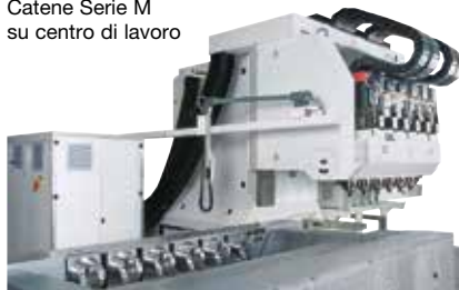
MT variante RMD su macchina lavorazione legno
