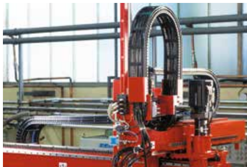
Conduttore dinamico di energia Quantum su manipolatore
