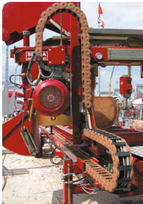
Catene con mescola al 85% costituita da legno installata su macchina sezionatrice
