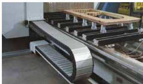
MT variante RMD su macchina lavorazione legno
