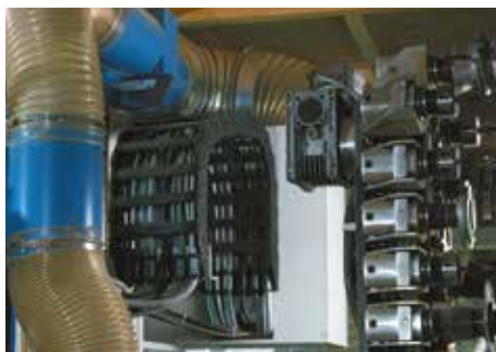
Uniflex su macchina lavorazione legno
