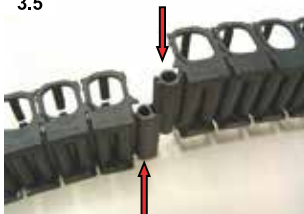
Tirare i laterali della catena per smontare la banda fino alla congiunzione successiva
