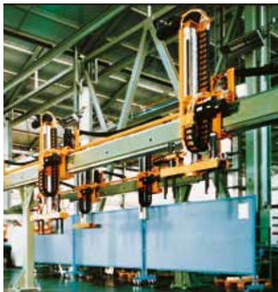
Catene Mono su impianto automatico
