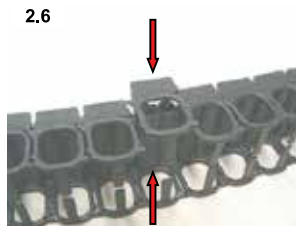
Sollevare la banda laterale posteriore procedere come da fig. 2.4 + 2.5. Infine agganciare nuovamente le due parti con una leggera pressione.
