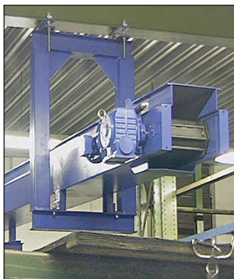
Convogliatore incernierato su impianto bunker
