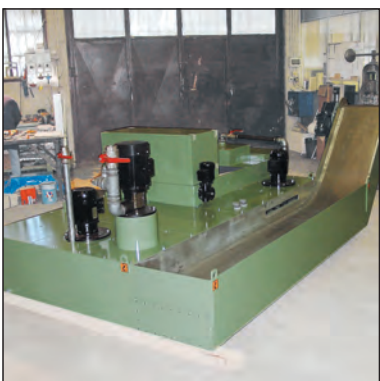
Impianto convogliatore magnetico completo di filtro a tessuto
