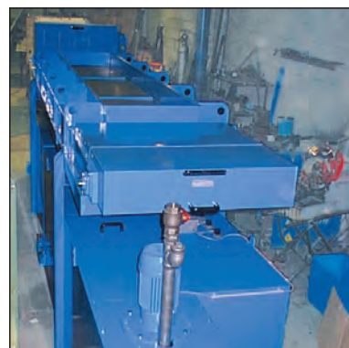
Impianto con filtro a tessuto, portata 1100 litri con doppio scarico del liquido
