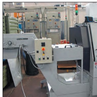
Convogliatore a tappeto integrale per tornio CNC, autonomo, completo di vaschetta di raccolta pezzi lunghi
