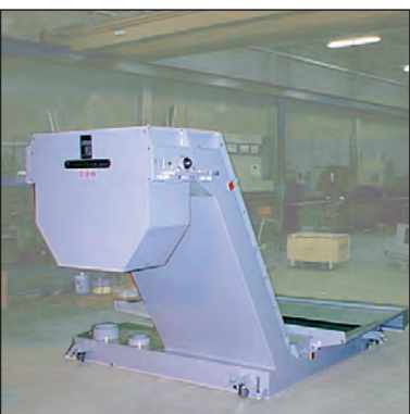
Convogliatore a tappeto incernierato per tornio CNC
