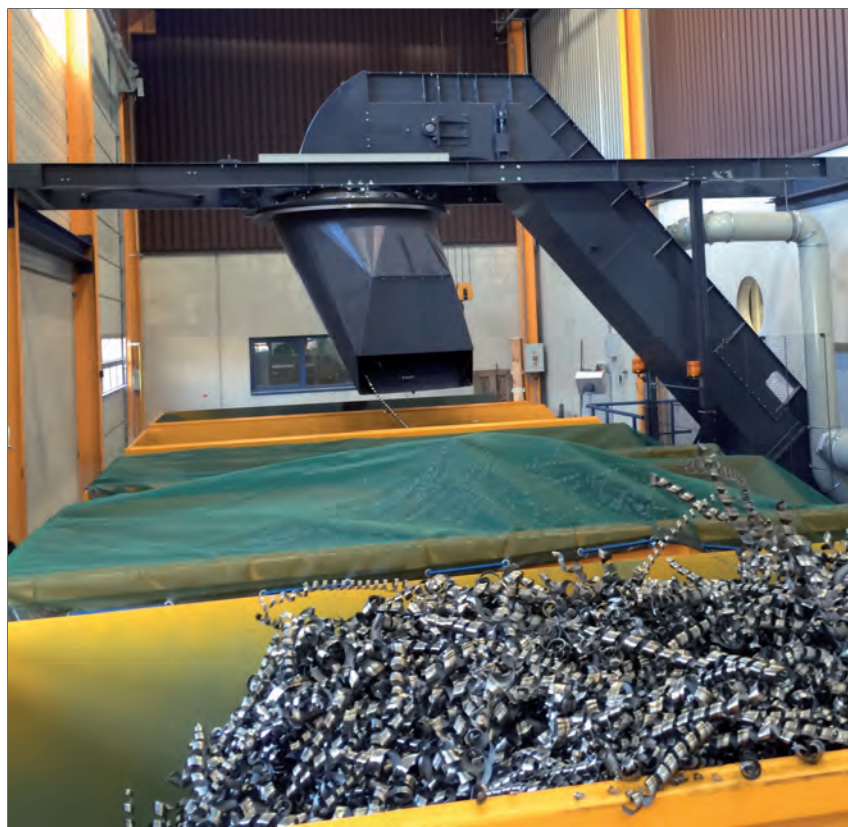
Smaltimento trucioli e distribuzione sfridi in più container su pelatrice
