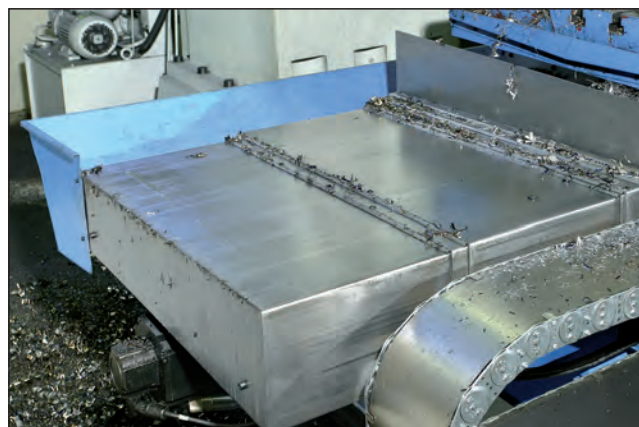
Copertura telescopica su una fresatrice, montaggio orizzontale
