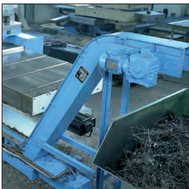
Convogliatore a tappeto incernierato su foratrice CNC
