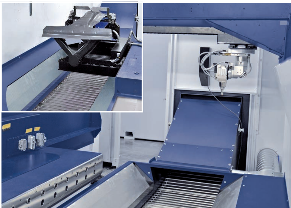
Konfigurácia dopravníkového systému na laserovom vyrezávacom stroji. Conveyor system configuration on a laser cutting machine.
