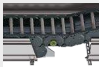
Chaîne à roulement pour des courses jusqu'à 1200 m
